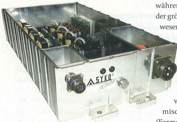
schlenkreis-Abblockung an Buck/Boost, Gegentaktstufe und Hochstromausgängen ohne Drosseln setzte Syko entsprechend dem Effektivstrom der Leistungsstufe die erforderliche Anzahl parallel geschalteter Kondensatoren ein. Dabei wird durch Mehrlagen-Leiterplatten auf eine gute Aufteilung des Gesamtstromes auf die einzelnen Kondensatoren geachtet.
