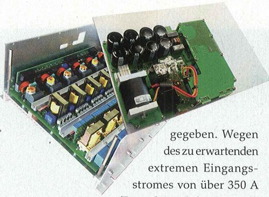
**Der Batteriewechselrichter WER. H6D.24.230.300/4 macht aus 18/19 bis 36 V am Eingang 236 V/50 Hz am Ausgang (3 kW, dynamisch 4,2 kW). Das abgedeckte Frontend wird mit  $n \times 3/4,2$  kW als Potentialtrennstufe kaskadiert.**
